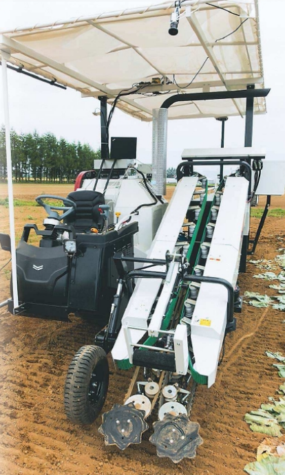
AIが判断するキャベツの自動収穫機 (立命館大学提供)
